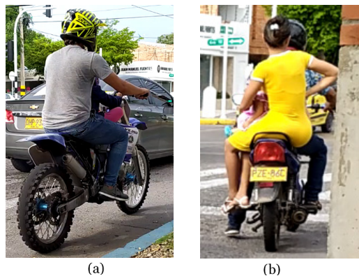
Figura 3 – (a) Matrícula con un ángulo que no permite el reconocimiento; (b) Matrícula con sobreexposición a la luz
